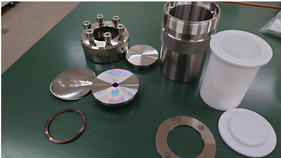
図1. 高温高圧酸分解容器の一式 (Model 4748: Parr社製). 白色のテフロンビーカーの中に、ジルコンをフッ酸に浸漬させた蓋付マイクロバイアルを入れ、金属製のジャケットで密閉して電気炉で加熱する.
